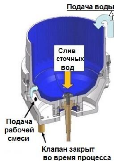
Рис.3.1 Контейнер с зазором 0 мм
