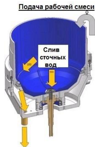
Рис.3.2 Контейнер с зазором 0,4 мм
